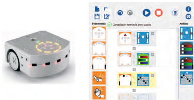
Le robot Thymio II (à gauche) et l'environnement de programmation graphique VPL 1.5 (au centre et à droite)
