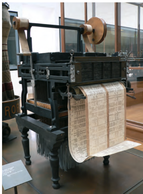
Mécanisme Jacquard (extrait d'un métier à tisser) exposé au musée des Arts et Métiers de Paris.
