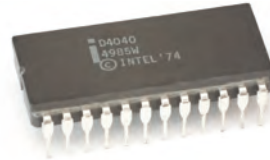
Microprocesseur Intel© 4040 de 1974. Contient 3 000 transistors
