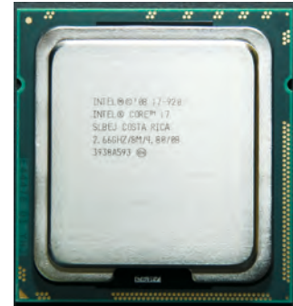
Microprocesseur Intel© Core i7 de 2014. Contient 2,6 milliards de transistors
