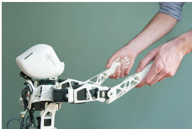
Le robot humanoïde Poppy est open source . Il est développé par l'Inria à la fois pour des recherches sur la cognition et pour des projets éducatifs. Plus de détails sur : https://www.poppy-project.org
