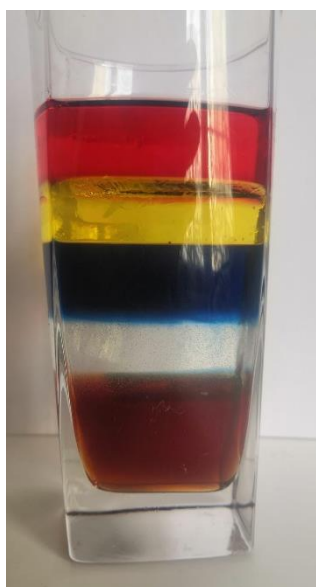
Tour de liquides : (de haut en bas) alcool ménager + colorant rouge, huile, eau + colorant bleu, liquide vaisselle, sirop de framboise.
