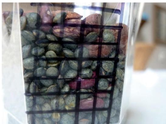
***Quadrillage tracé sur le récipient pour voir l'hétérogénéité du mélange.***
