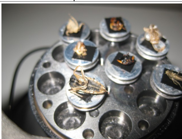
Nos bestioles métallisées et placées sur une platine pour pouvoir être observées.
