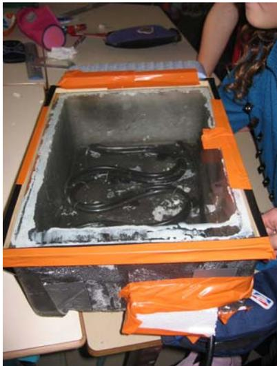
Un deuxième test a été réalisé avec les capteurs améliorés et la température la plus élevée a été  $38^{\circ}$  pour une exposition de 2 heures par  $5^{\circ}$  de température extérieure.
