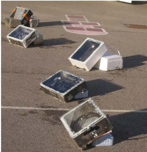
Les cinq capteurs opérationnels ont été placés dans la cour face au soleil en même temps et ont été laissés pendant 1h00. Au bout de ce temps, ils ont été rentrés dans la classe et la température de l'eau a été mesurée.
