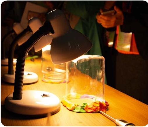
Mesure de la température à l'intérieur et à l'extérieur de la serre
