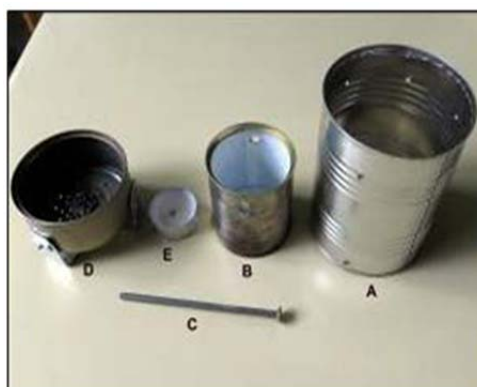
Figure 5.2 : Matériel pour fabriquer le calorimètre.
