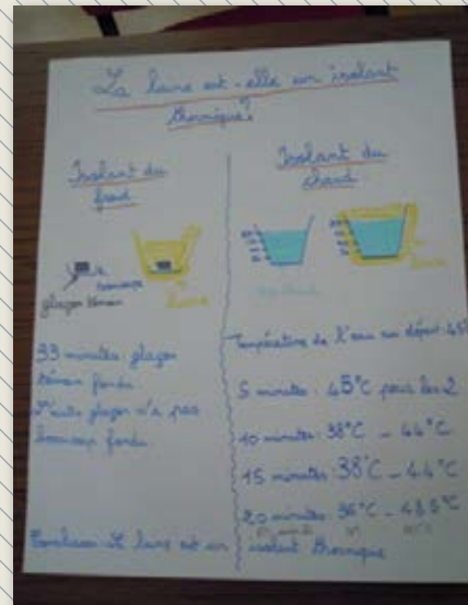
Affiche montrant un protocole expérimental pour tester les capacités isolantes de la laine (comprenant les données recueillies et une conclusion).
