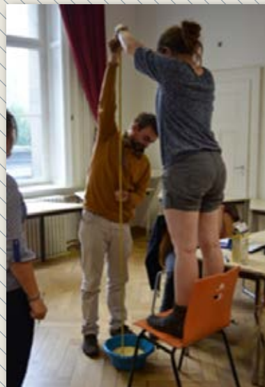
Enseignants réalisant une expérience pour tester, par modélisation, les paramètres dont dépend le diamètre d'un cratère.
