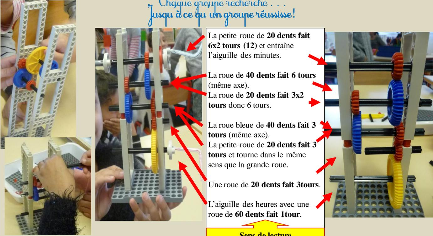
La petite roue de **20 dents fait 6x2 tours (12)** et entraîne l'aiguille des minutes.
