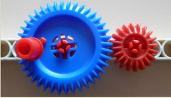
Nous avons construit un **engrenage** de 2 roues. **Si la roue menante tourne dans un sens, la roue menée tourne en sens inverse.** Si la grande roue de 40 dents fait 1 tour, la petite de 20 dents fait 2 tours. Si la grande roue de 60 dents fait 1 tour, la petite de 20 dents fait 3 tours.
