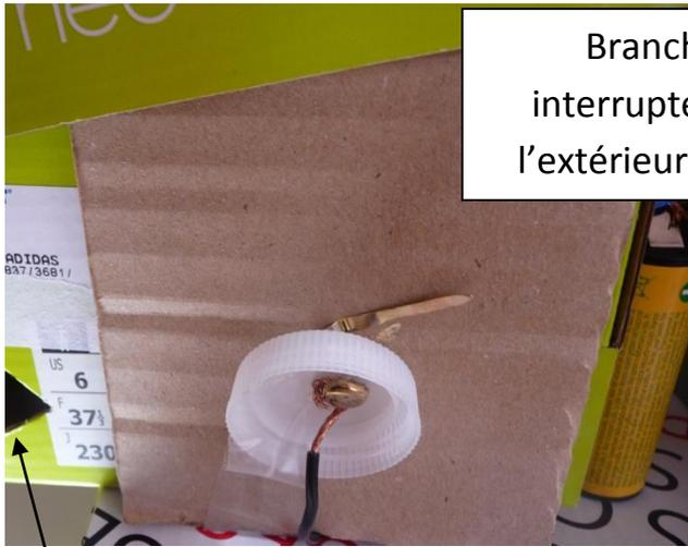
Branchements interrupteur et pile à l'extérieur de la boîte.
