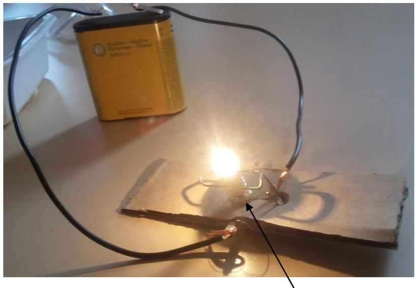
Insertion entre le culot et l'attache parisienne, d'un bout de papier aluminium, pour un meilleur contact.
