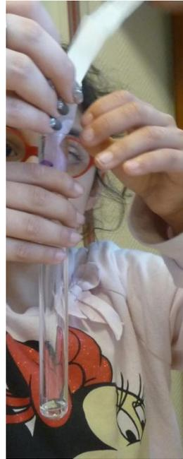
insertion de la bande de papier dans un tube à essai contenant un mélange d'acétone (dissolvant) + éthanol (alcool à brûler)
