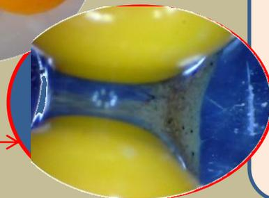
**L'eau sert à maintenir le sable sec en créant un pont entre les grains mais s'il y a trop d'eau le sable ne sera plus maintenu.**
