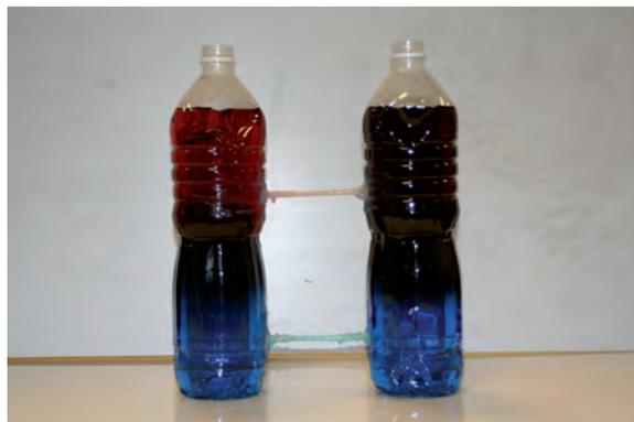
Au bout d'une dizaine de minutes, le résultat est assez parlant: l'eau froide (bleue) et l'eau chaude (rouge) ont circulé entre les deux bouteilles. L'eau froide, plus dense, circule dans la paille du bas, et l'eau chaude, moins dense, circule dans la paille du haut.
