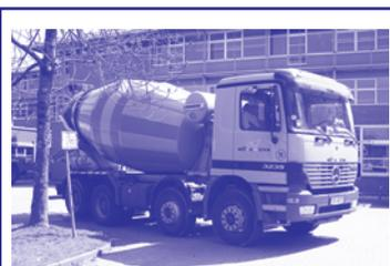
Pour transporter du béton sur un chantier, on commande un mélange tout fait qui est livré par un camion spécial. Ce camion a une forme ronde, la toupie, qui doit toujours tourner pour que le béton ne durcisse pas pendant le trajet. Cela consomme de l'énergie et pollue.
