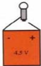
Circuit ouvert, l'ampoule ne brillera pas
