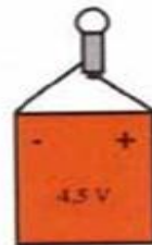
Circuit fermé correct, l'ampoule brillera
