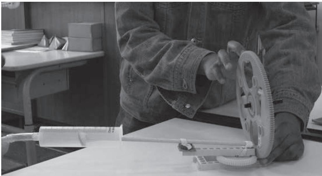
Le mouvement de rotation de la roue horizontale (roue-manivelle) est obtenu grâce à celui de la roue verticale (roue menante)
