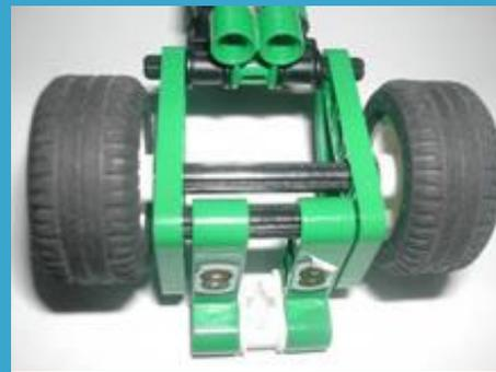
Système arbre avec des roues enfoncées en force. Facile mais il faut guider l'arbre. Ici des trous sont prévus dans le châssis.
