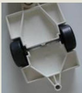
Système arbre avec des roues enfoncées en force. Faire tenir l'arbre, ici clipsé sur le châssis, est très difficile à réaliser.
