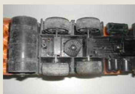
Système arbre et roues assemblées en force. L'arbre est guidé par une forme cylindrique moulée dans le châssis. Facile à comprendre, mais difficile à réaliser.
