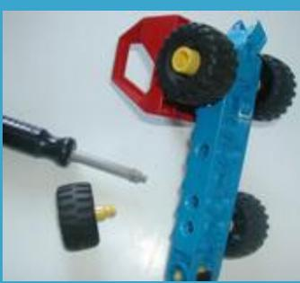
Système roue/axe. L'axe se visse dans le châssis.
