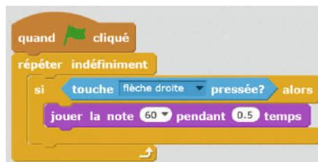
Exemple de branchement de *Makey-Makey* (à gauche) et programme *Scratch* (à droite) pour jouer une note lorsque le contact électrique est rétabli.
