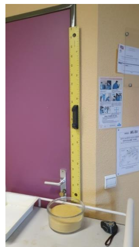
Un saladier transparent de 20 cm de diamètre est rempli de semoule (sur une épaisseur d'environ 5 cm) et une règle de 1 m est placée derrière le saladier, de façon à ce que le trait du 0 corresponde à la surface.
