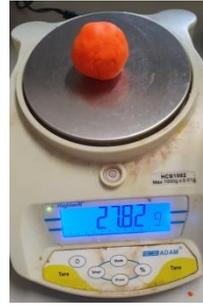
**Pour modéliser les météorites, ces deux boules ont été fabriquées en recouvrant le cube en acier et la bille en verre rouge de pâte à modeler (photo à gauche). Les élèves vérifient que les deux boules ont un diamètre similaire grâce à un pied à coulisse (photo au milieu) et ajoutent de la pâte à modeler si nécessaire. Enfin, la masse totale des objets est mesurée à l'aide d'une balance (photo à droite) : environ 28 g pour la première et 65 g pour la seconde.**
