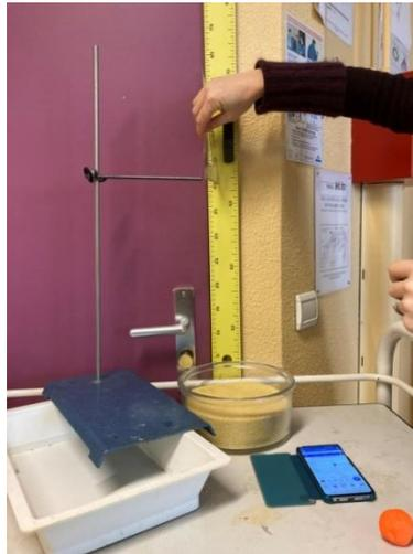
**Exemple de dispositif utilisé pour ce défi : une règle de 1 m est placée derrière le saladier rempli de semoule, et un support de laboratoire et une équerre sont utilisés pour repérer facilement une hauteur donnée. Un smartphone est placé à proximité du saladier afin de réaliser les mesures propres au défi « Cratères et météorites (2/2) : Chute de météorites : Mesure du séisme à l'impact ».**
