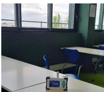
**Objectif général :** Comprendre qu'une atmosphère trop chargée en CO<sub>2</sub> est délétère pour la santé. Utiliser le détecteur de CO<sub>2</sub> pour faire des mesures permettant de déterminer la fréquence et la durée d'aération d'une pièce pour avoir un air « sain ».
