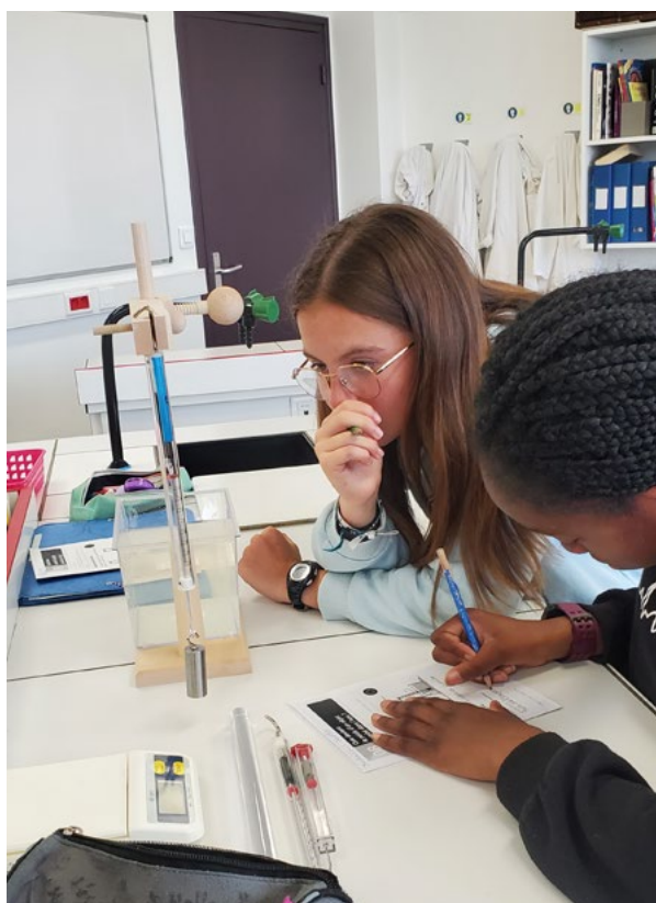
Mesure du poids dans l'eau et hors de l'eau avec le dynamomètre.
