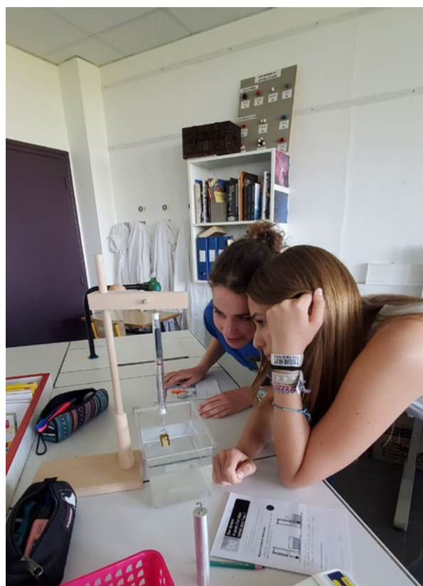
Mesure du poids dans l'eau et hors de l'eau avec le dynamomètre.
