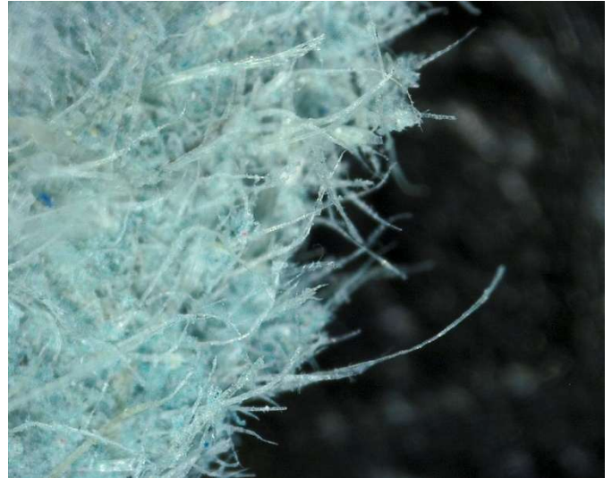
Photographie en microscopie optique d'une feuille de papier bleu clair
