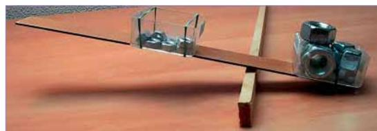
Si la fuerza de la caja de la izquierda se ejerce demasiado cerca del punto de apoyo, la carga no se puede levantar.
