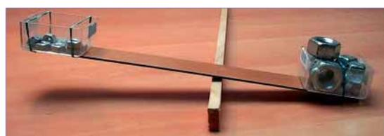
En esta configuración, la fuerza ejercida por las seis pequeñas tuercas colocadas en la caja de la izquierda no es suficiente para levantar la carga (las cinco tuercas grandes de la caja de la derecha).
