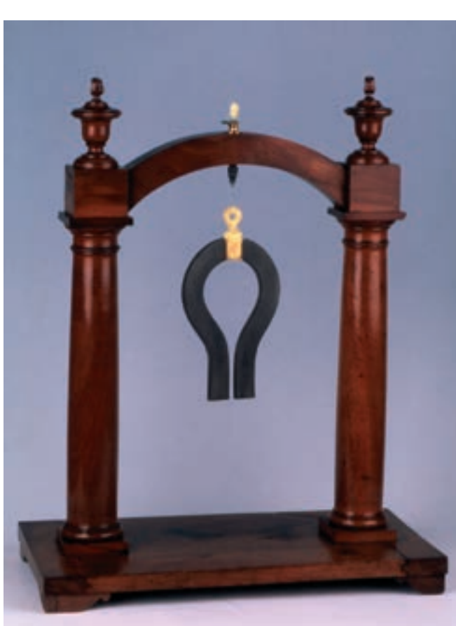
Faisceau magnétique (assemblage d'aimants en fer à cheval)
