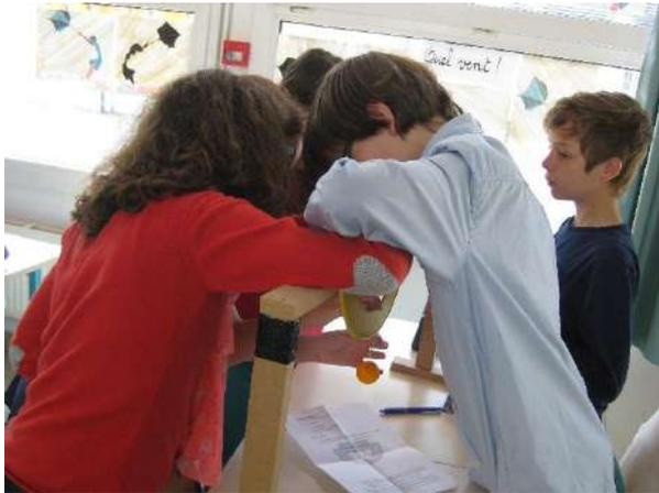
Sur cet instrument de mesure, la balle de ping-pong accrochée à une ficelle est attachée au rapporteur. Lorsqu'il n'y a pas de vent, l'angle indiqué est de  $90^\circ$  par rapport à la ligne horizontale.
