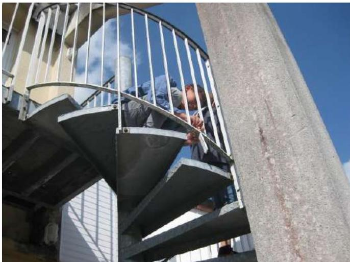
Cet escalier en colimaçon ne permettait pas de placer les thermomètres avec la même exposition au soleil. Par ailleurs, certains thermomètres touchaient les marches métalliques de l'escalier alors que d'autres non. Il a fallu résoudre ce problème.
