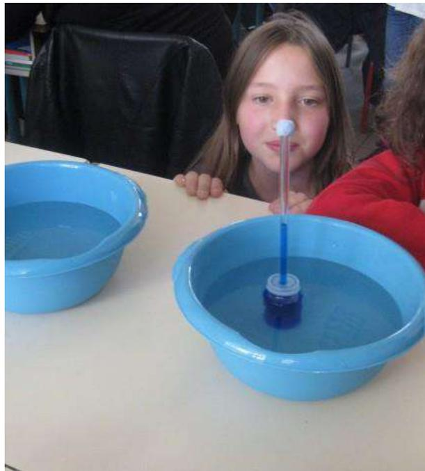
La mise en commun des résultats de l'expérimentation a permis de conclure que les dispositifs fonctionnaient avec de l'eau ou de l'alcool mais que la peinture n'est pas adaptée car elle colore le tube et on ne peut pas voir si elle redescend en cas de baisse de température.
