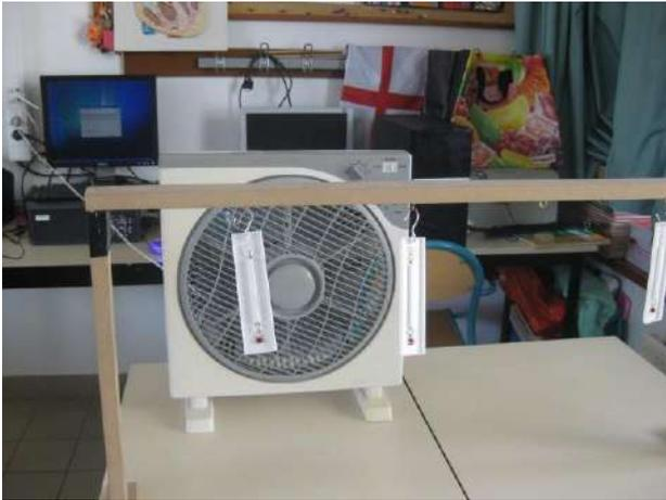
Nous avons utilisé une potence pour maintenir les thermomètres : deux thermomètres dans le flux d'air et un thermomètre en dehors du flux d'air.
