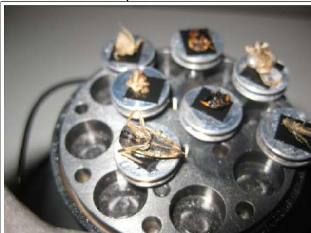
Nos bestioles métallisées et placées sur une platine pour pouvoir être observées.
