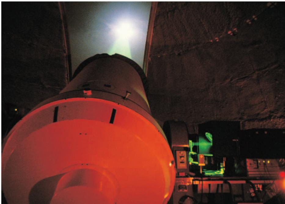
Ce télescope est utilisé pour mettre en forme et orienter le faisceau de lumière bleue produite par un puissant laser (source de lumière). Ce faisceau est réfléchi par des miroirs placés sur la surface de la Lune (lors d'une mission Apollo) ou sur un satellite artificiel, et le télescope recueille l'écho retour. Le temps d'aller-retour donne la distance à l'objet réfléchissant, à une précision de l'ordre du centimètre.
