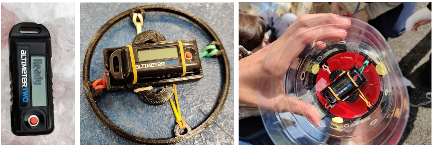
Le module d'enregistrement « Altimetertwo » sur un support fabriqué à l'imprimante 3D.
