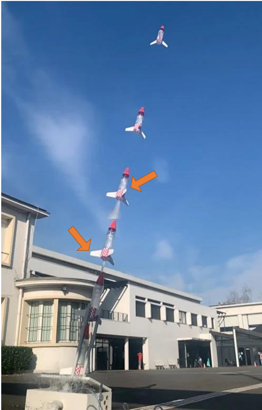
Observation image par image des ailerons rigides au décollage.
