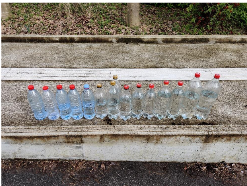
Remplissage des fusées avec différentes quantités d'eau
