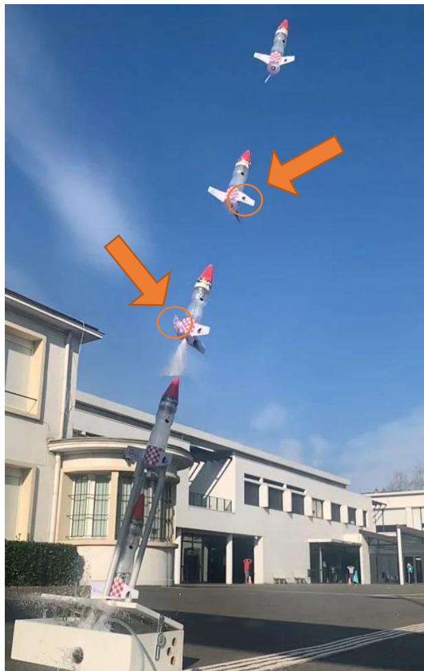
Observation image par image de la déformation des ailerons au décollage.
