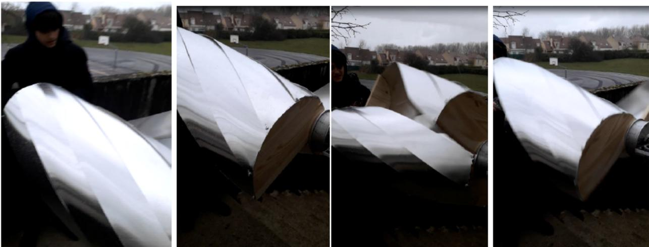
Ces expériences leur ont permis d'apporter des corrections et des améliorations sur le système de fixation et sur comment faire des démonstrations dans un endroit clos sans vent en utilisant un des moteurs pour tourner l'éolienne et générer de l'électricité avec l'autre moteur et faire des tests de démonstration.
