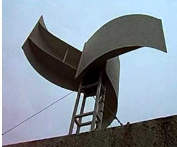
On trouve également des modèles à 2 pales qui sont un peu tordues pour permettre au vent de s'engouffrer quelle que soit la position initiale de l'éolienne comme sur l'image ci-dessous.
