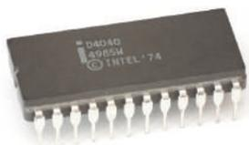
Microprocesseur Intel© 4040 de 1974. Contient 3 000 transistors
