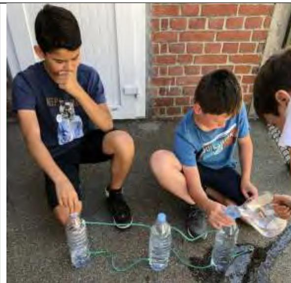
L'expérience est concluante, lorsqu'on remplit la première cuve, les autres se remplissent au même rythme puisque l'eau passe par les tuyaux qui relient les cuves.
