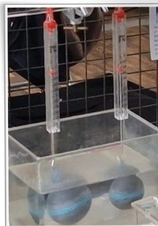
Titre : Effet de la poussée d'Archimède sur des objets de volume différents mais de même masse.
