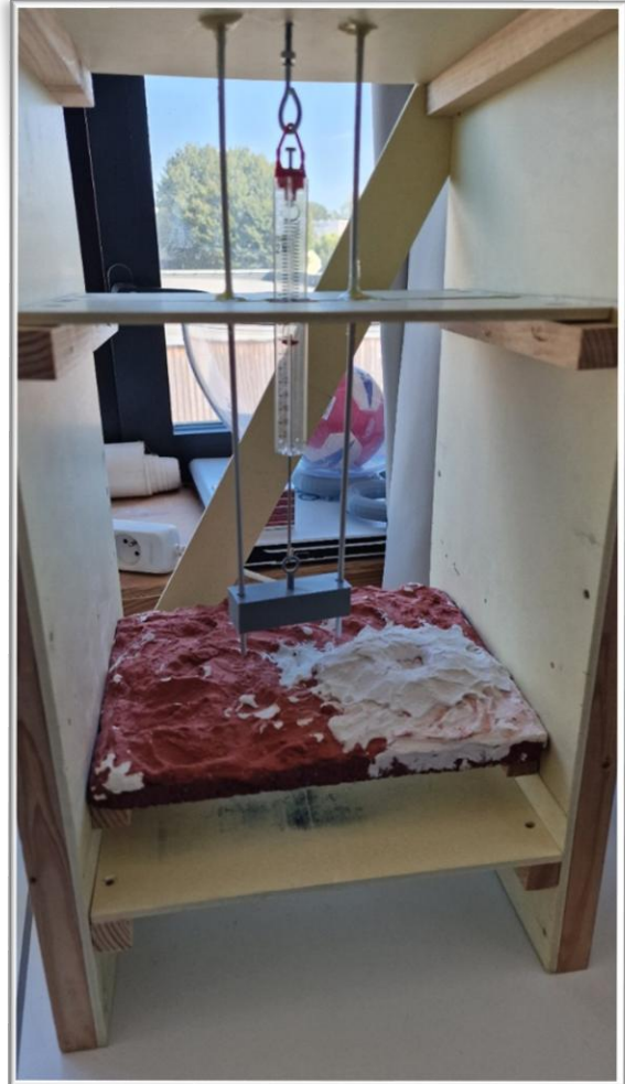
Titre : Maquette permettant d'illustrer un poids plus faible sur Mars que sur Terre. Le décor martien peut être remplacé par un décor Terrestre. L'utilisation d'aimants permet à la nacelle de se retrouver plus proche du sol sur Terre que sur Mars.
