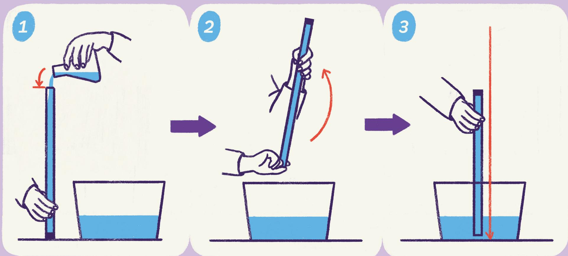
C'est la pression atmosphérique qui appuie sur l'eau du récipient. Dans le tube, il n'y a pas d'air, et aucune pression n'est exercée sur l'eau.
