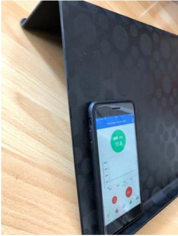
L'inclinomètre de ton smartphone ou de ta tablette a la même fonction que le niveau à bulle utilisé par les maçons pour vérifier qu'un plancher est bien horizontal.
