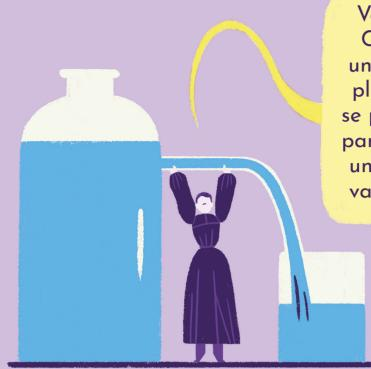
Voici un grand réservoir d'eau. Ce réservoir communique par un tube à un vase. Si le vase est plus élevé que le réservoir, il ne se passe rien ; s'il est moins élevé, par l'extrémité du tube s'échappe un jet d'eau qui s'écoule dans le vase. C'est ainsi que l'eau arrive dans nos maisons.
